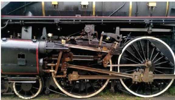
Samt Tender ist die 241.A.65 16 m lang und insgesamt 200t schwer, davon 35t Wasser und 8t Kohle. Die grossen Räder haben einen Durchmesser von 1.96 m. Sie kann 3'500 PS leisten und eine maximale Geschwindigkeit von 110 km/h erreichen. Leider konnten wir damit nicht fahren. Immerhin sind 2025 wieder Fahrten vorgesehen. (s. auch [www.241a65.ch](http://www.241a65.ch))
